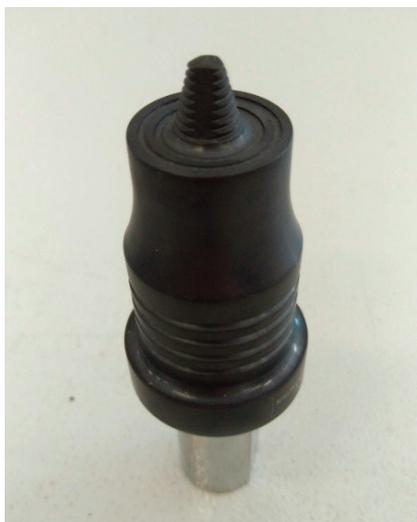
Рис. 1. Монолитный инструмент с неподвижным стержнем
