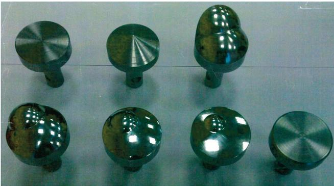
Рис. 2. Сферобойки для физического моделирования эффекта сферодинамики
