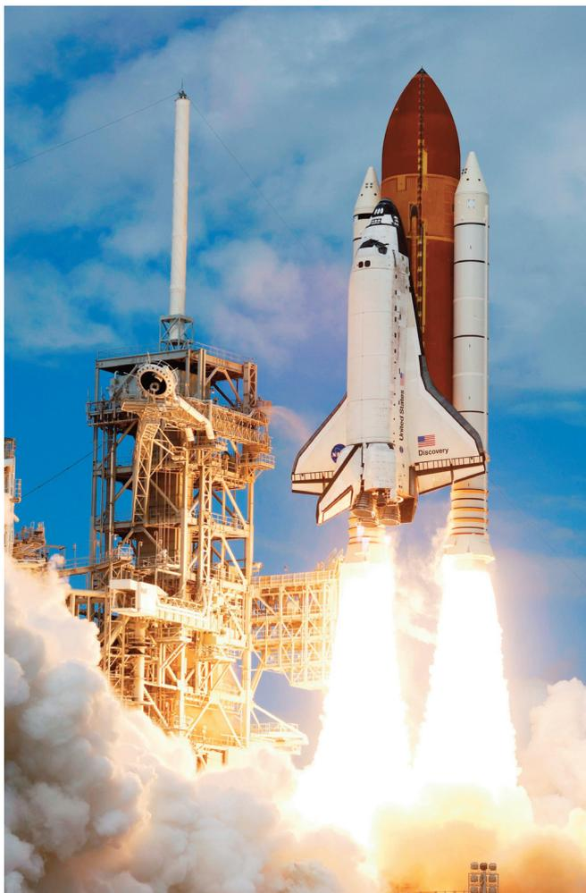
и перезаправки, используются вновь. Внешний топливный бак с жидкими водородом и кислородом служит звеном для соединения ускорителей с космическим кораблём. Бак отбрасывается примерно через 8,5 мин. после старта, большая часть его сгорает в атмосфере, а остатки падают в океан. Космический корабль выходит на околоземную орбиту. После выполнения программы полёта возвращается на Землю и совершает посадку как планер на взлётно-посадочную полосу.
