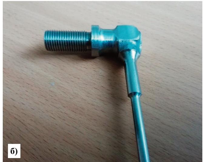
Рис. 2. Опытные образцы из стали 12Х18Н10Т: а) внешний вид образцов, б) паяный шов
