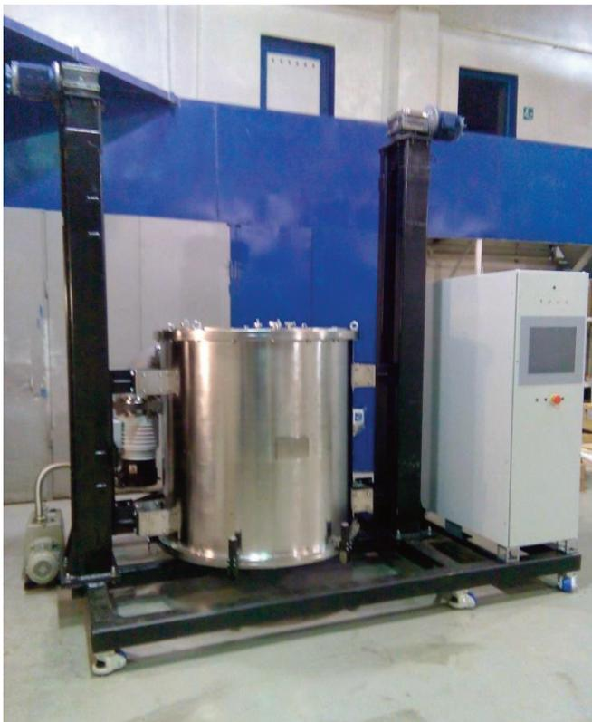
Рис. 4. Установка для пайки в высоком вакууме
