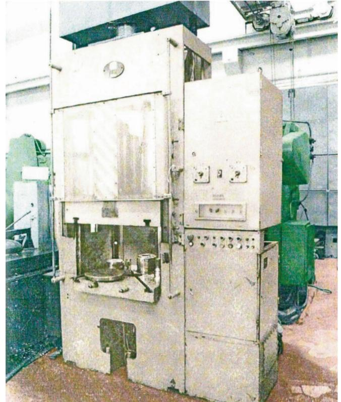
Рис. 3. Гидравлический пресс мод. НРК70S,  $P=70$  кН,  $V_{тр} = 4$  мм/сек
