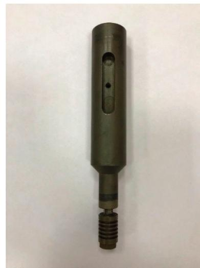
Рис. 3. Инструмент типа «Bobbin-Tool»
